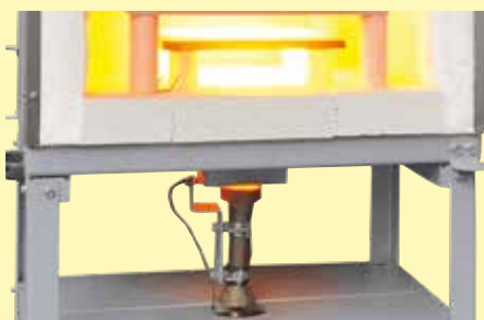
Propangasbrænder med 15 kW, monteret under ovnen
